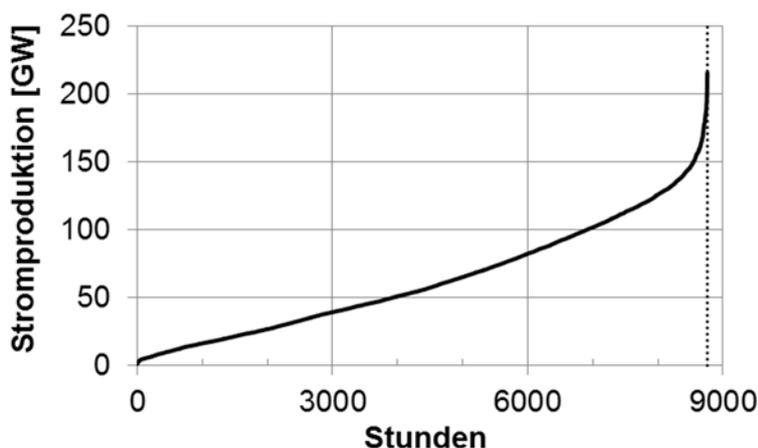
**Abbildung 55: Fiktive Jahresstromproduktion (8760 Stunden) für 200 GW<sub>p</sub> PV und 200 GW<sub>p</sub> Wind, extrapoliert auf Basis von Installations- und Ertragsdaten des Jahres 2017**
