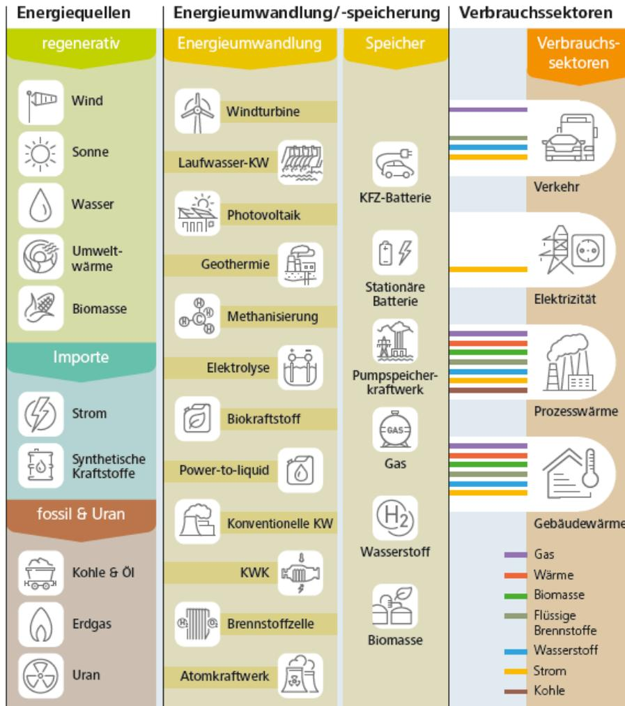
**Abbildung 46: Schematische Darstellung des Modells REMod (KW: Kraftwerk, KWK: Kraft-Wärme-Kopplung, [ISE12])**
