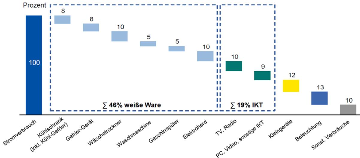
**Abbildung 54: Stromverbrauch eines durchschnittlichen Haushalts ohne Warmwasseraufbereitung [RWE]**
