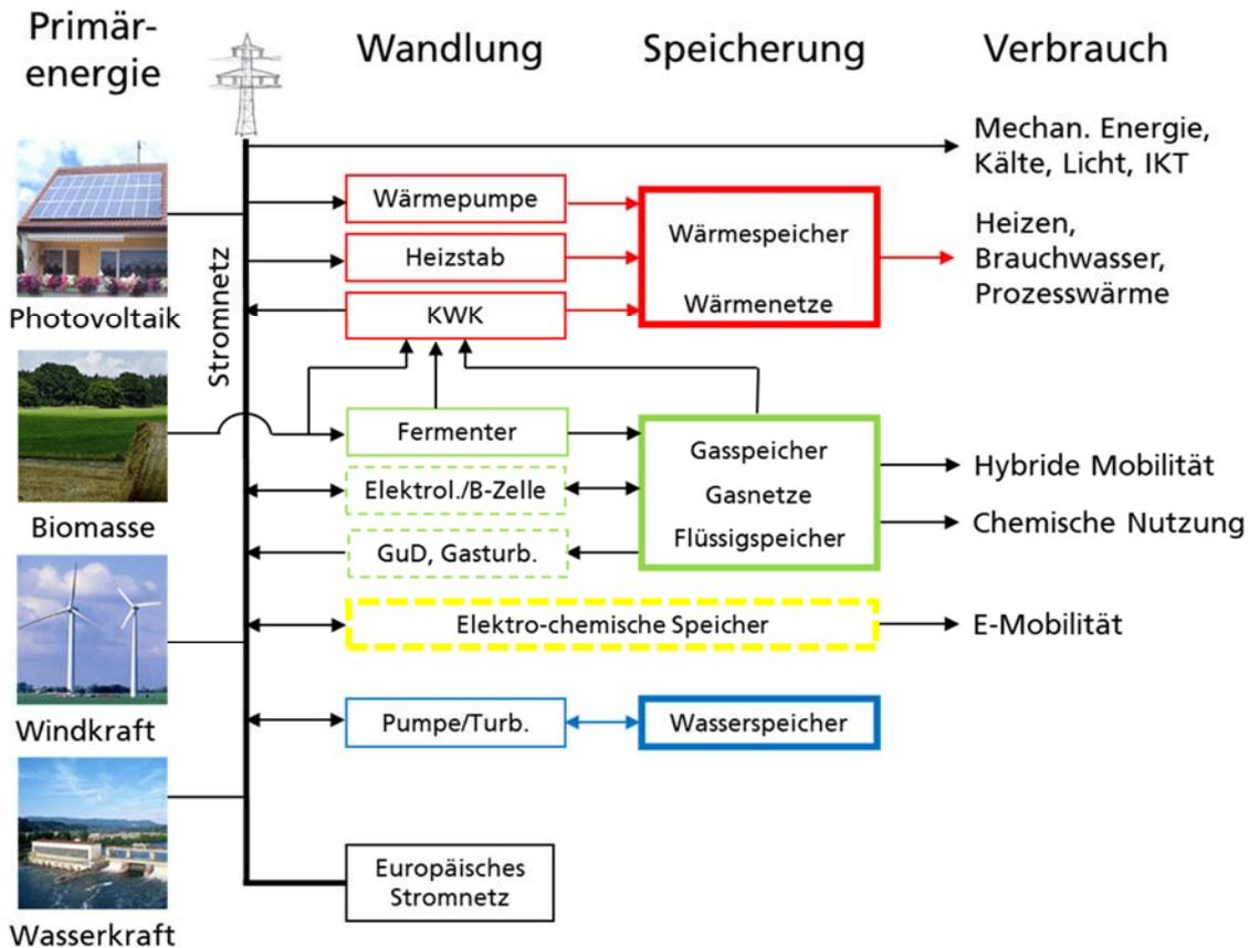
**Abbildung 61: Vereinfachte schematische Darstellung eines Erneuerbaren Energiesystems mit den wichtigsten stromnetzgebundenen Bausteinen der Kategorien Gewinnung, Wandlung, Speicherung und Verbrauch**
