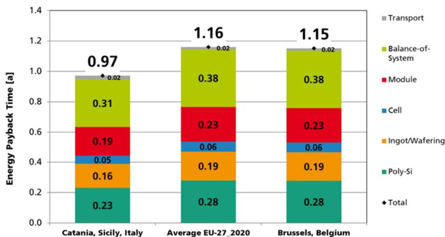
Abbildung 29: Berechnete Energierücklaufzeiten von PV-Kraftwerken für europäische Produktions- und Betriebsstandorte [ISE10], Daten: Lorenz Friedrich
