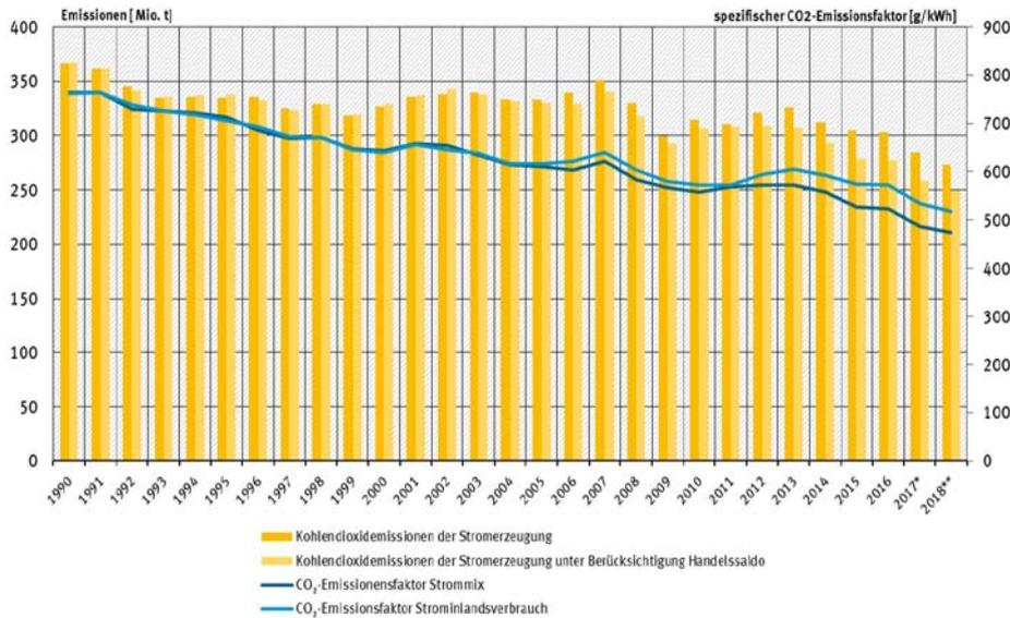
**Abbildung 39: Spezifische und absolute CO<sub>2</sub>-Emissionen der Stromerzeugung in Deutschland [UBA6]**
