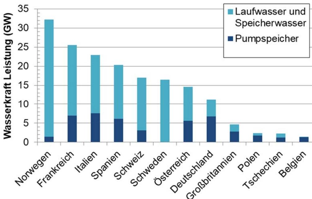
Abbildung 60: Installierte Leistung von Wasserkraftwerken in benachbarten Ländern, Zahlen aus [IHA]
