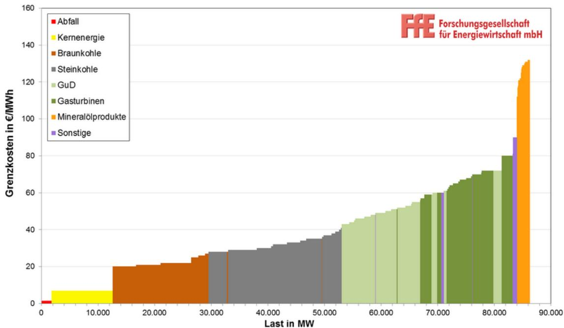
Abbildung 6: Merit Order konventioneller Kraftwerke im Jahr 2018 bei einem mittleren CO<sub>2</sub>-Zertifikatspreis von 16 €/t [FFE]
