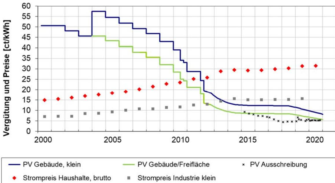
**Abbildung 4: EEG-Vergütung für PV-Strom nach dem Datum der Inbetriebnahme des Kraftwerks, mittlere Vergütung in den Ausschreibungen der Bundesnetzagentur, Strompreise, Daten aus [BMW1], [BDEW6]**
