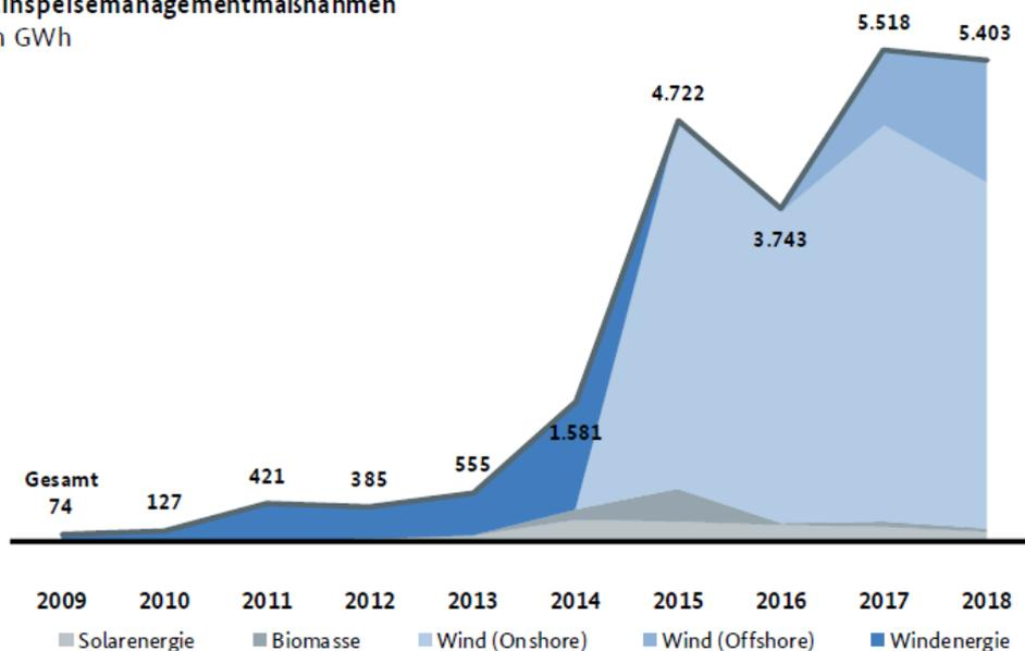
**Abbildung 22: Abgeregelt elektrische Energie [BNA]**
