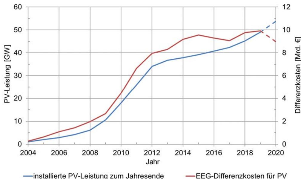
**Abbildung 8: PV-Ausbau und Vergütungssumme, Daten aus [BMWi1], [BMWi5]**
