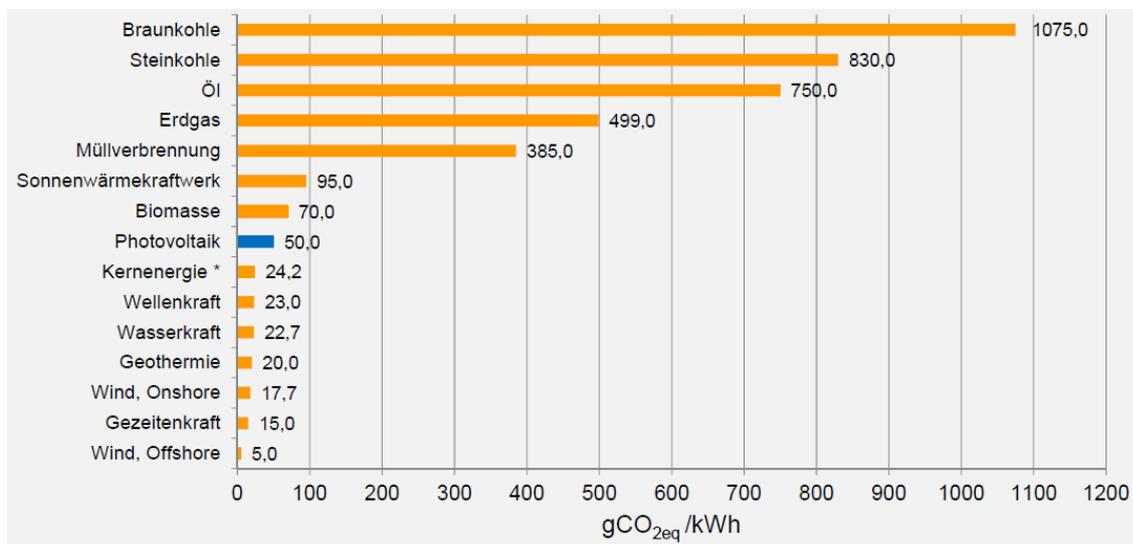
**Abbildung 38: Durchschnittliche CO<sub>2</sub>-Äquivalent Emissionen verschiedener Stromerzeugungstechnologien [EnAg]**
